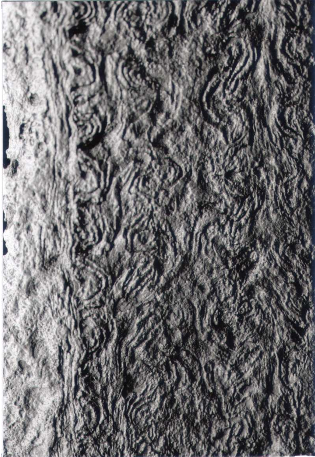
Abb. 48a: Schweißmustersausprägung in einer der zwei Zonen an Klinge B, die der ursprünglichen Oberfläche der Waffe am nächsten liegen (vergl. Abb. 60a, b).
