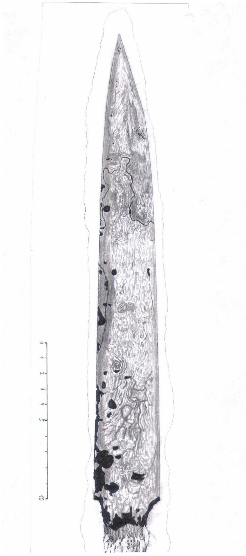
Abb. 28c: Umzeichnung der Konstruktionsnaht und der Härtebefunde an Klinge A.
