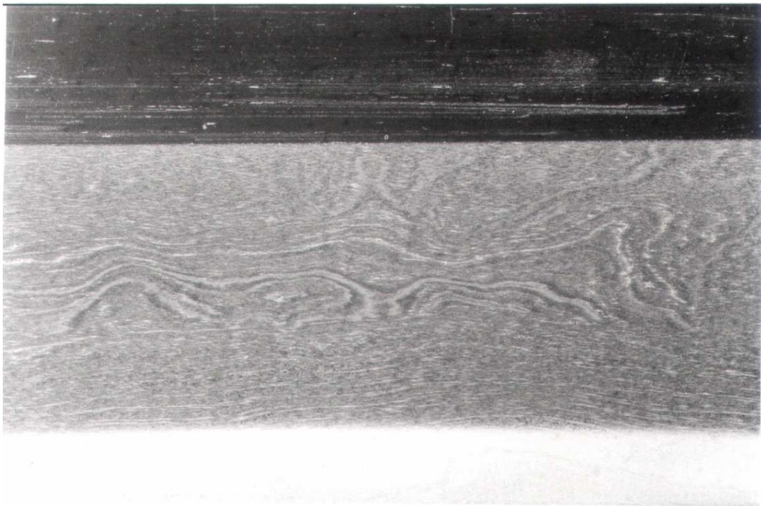
Abb. 36: Jihada und Ha eines Tachi der Sôshû-Tradition, das aufgrund der schmiede- und härtetechnischen Charakteristika dem Schmied Yukimitsu zugeschrieben wird. Das Schwert wird um 1300 datiert. Etwa in der Mitte des Ji ist die Grenze zwischen der Masame-hada und der Itame -Struktur der übrigen Flachseite deutlich zu erkennen. Die Konstruktionsschweißnaht zwischen den unterschiedlichen Materialien ist perfekt verschweißt. Die extrem feine Masame -Textur hat eine Entsprechung im Schneidenstahl der Spathaklinge B aus Neudingen
