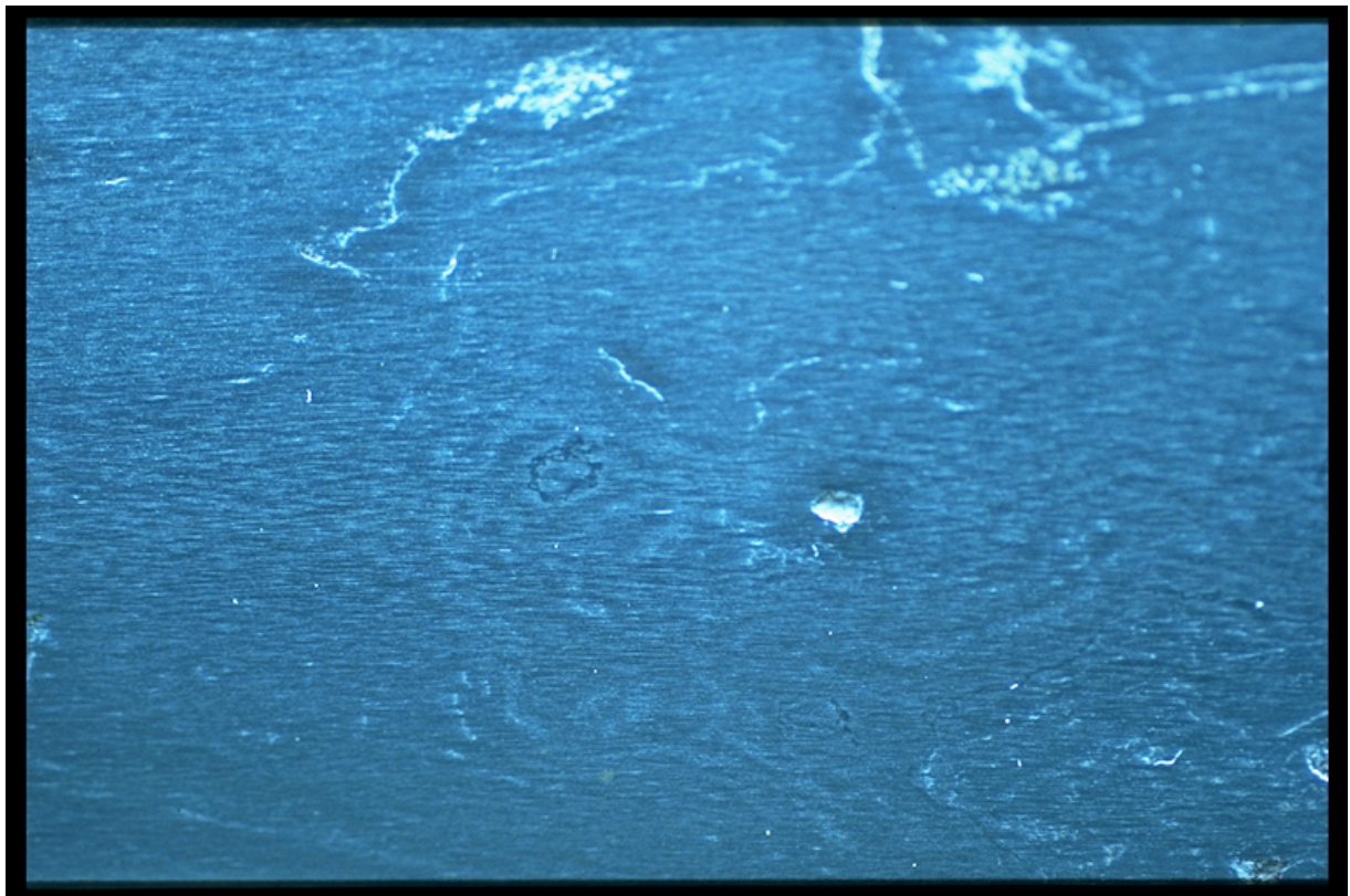
Abb. 27: Klinge A. Mokume -Wirbel im mittleren Bereich des Klingenblattes.
