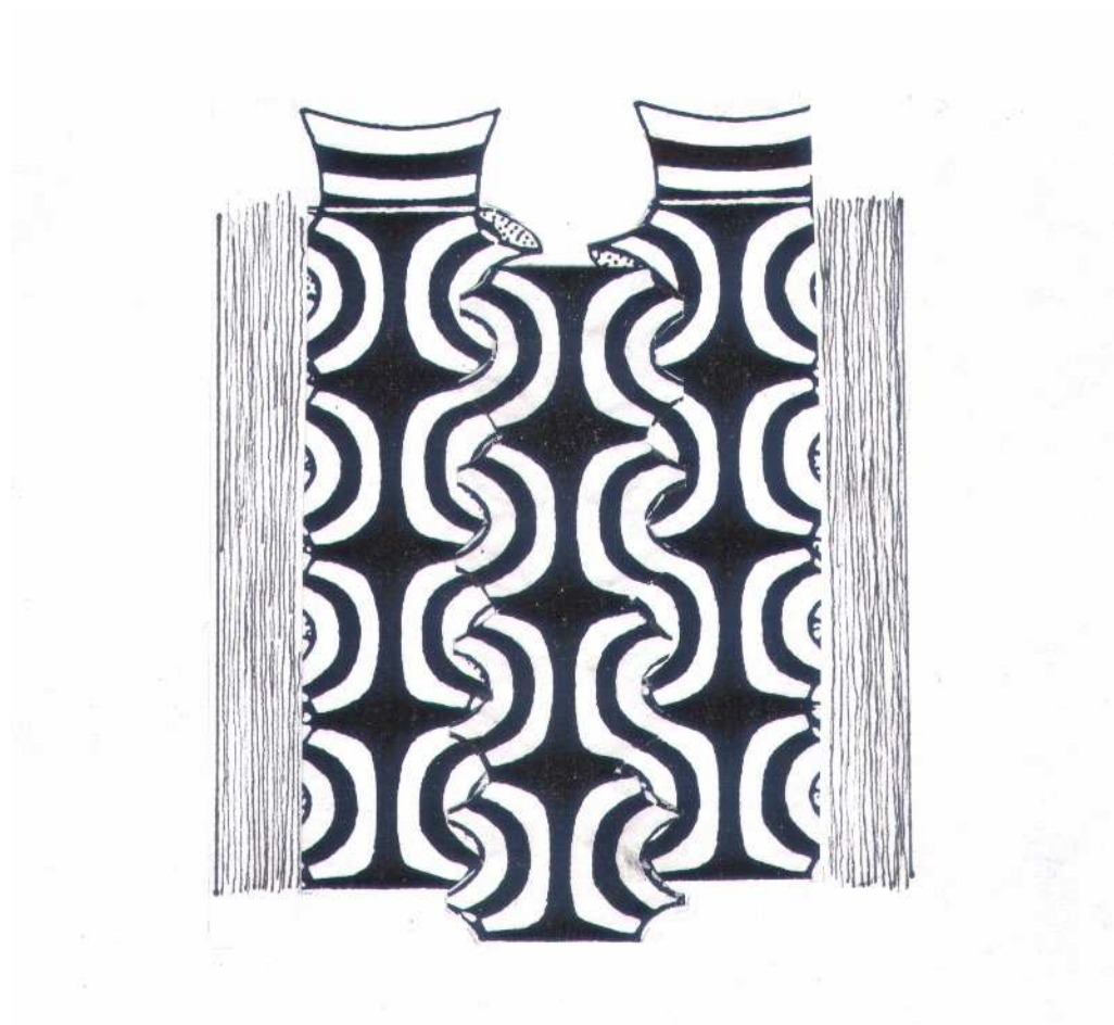
Abb. 59: Schematische Rekonstruktion des ursprünglichen Schweißmusters der Klinge B auf der Basis der Erkenntnisse von J. Ypey.
