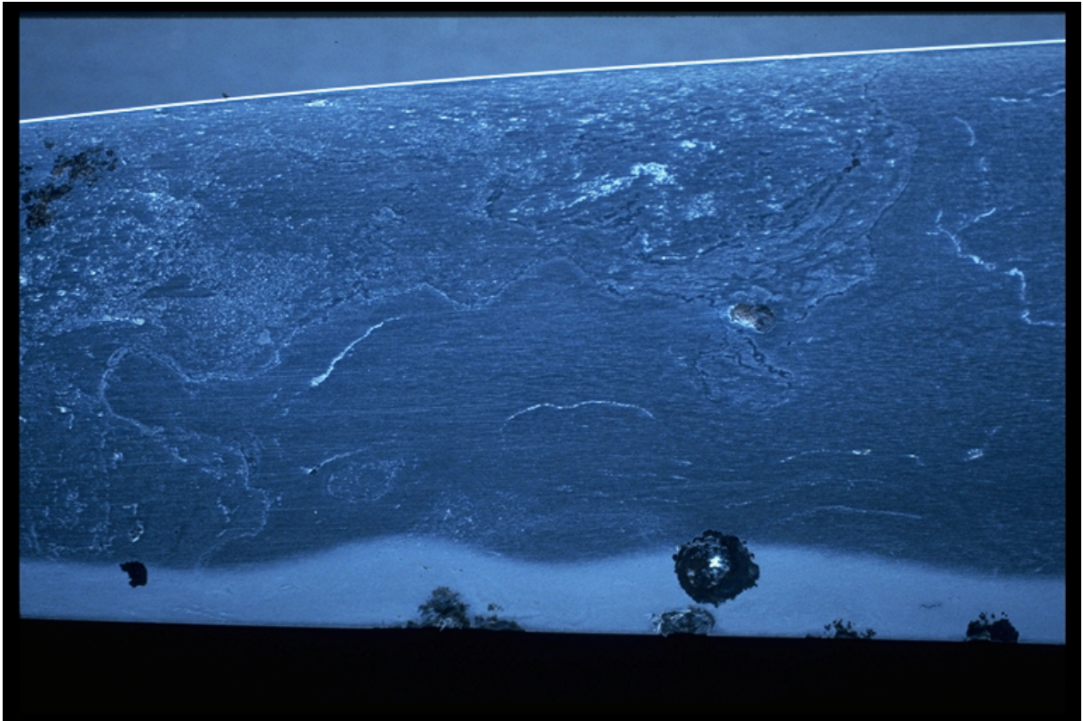
Abb. 29: Klinge A. Die Konstruktionsnaht vor dem Ortbereich. Zur Schneide hin sind im Kernstahl zwei Bereiche auszumachen, deren Erscheinungsbild aufgrund der helleren Texturbestandteile mit demjenigen des Materials im Ortbereich übereinstimmt. Sie sind als Überreste des Mantelstahls anzusprechen.
