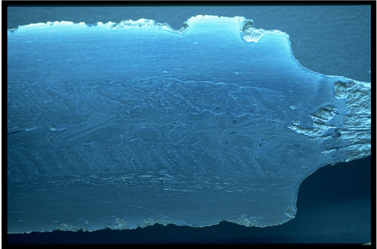
Abb. 50a: Polierter Schulterbereich der Spathaklinge B. Es ist gut zu erkennen, wie die drei Musterbahnen zur Griffangel hin, aus der Mitte der Klinge abwandern. Der unterste Kompositstab läuft in die Klingenschulter rechts unten im Bild aus. Die extrem feine Masame -Textur des Schneidenstahles kommt am unteren Bildrand gut zur Geltung. Dasselbe gilt für die Verzahnung der Musterbahnen mit den Schneiden.
