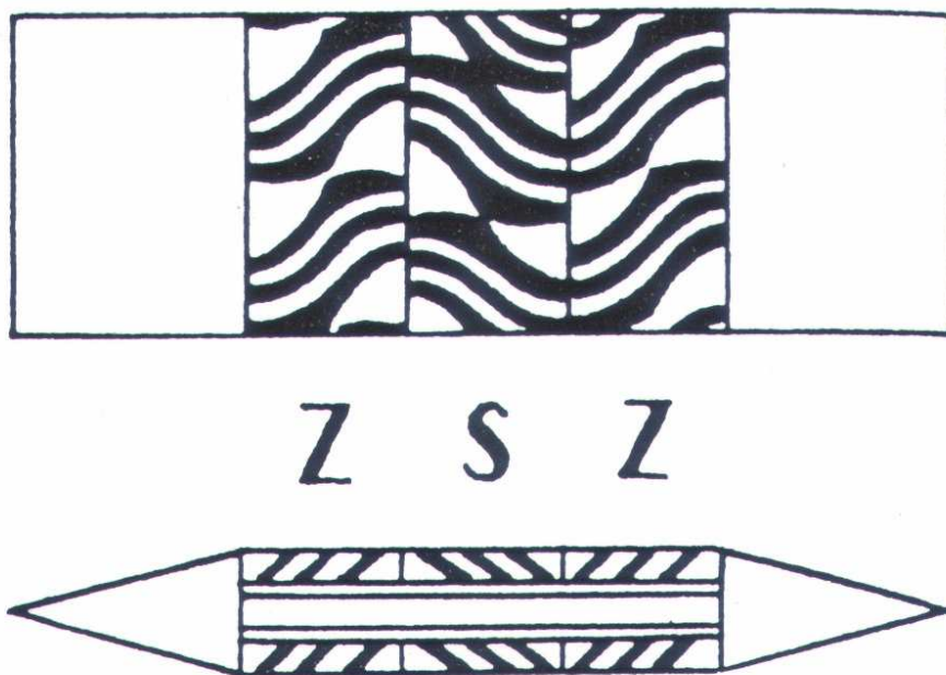
Abb. 52: Schematische Darstellung der Torsionsrichtungen an Kompositstäben (nach Ypey, 1983b).
